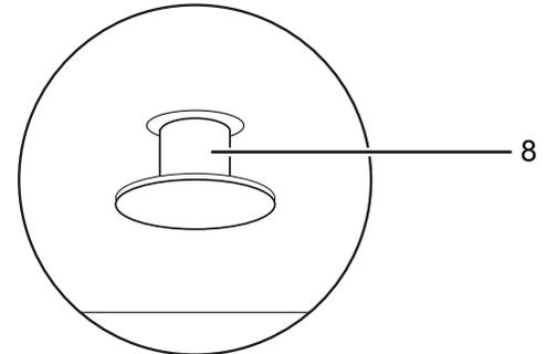
Erst wenn der Kippschutz-Schalter vollständig in das Gerät eingeschoben wurde, kann das Gerät genutzt werden. Das passiert automatisch, wenn Sie das Gerät auf einen geeigneten Untergrund stellen.
