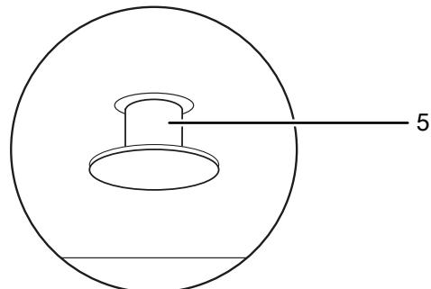
Μόνο όταν ο διακόπτης προστασίας από ανατροπή (5) έχει εισαχθεί πλήρως μέσα στη συσκευή, μπορεί να χρησιμοποιηθεί η συσκευή. Αυτό συμβαίνει αυτόματα όταν τοποθετείτε τη συσκευή σε κατάλληλο υπόστρωμα.
