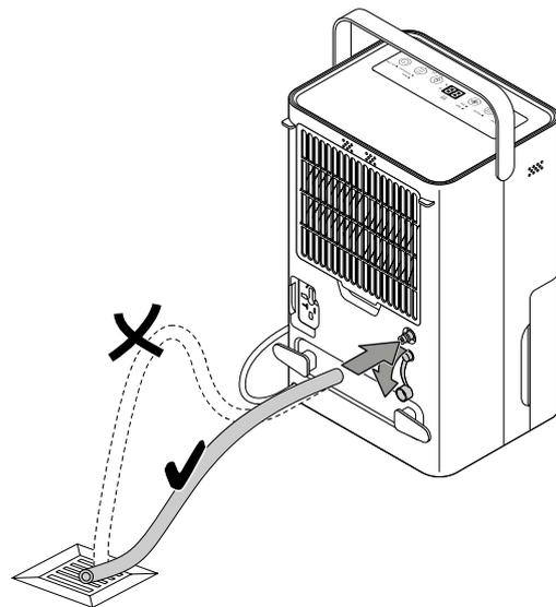
4. Fjern slangen hvis kondensen igjen skal samles opp via kondensbeholderen. La slangen tørke godt før lagring.
