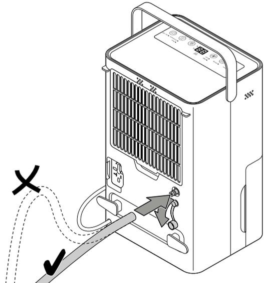
3. Før den andre enden av slangen til et egnet avløp (f.eks. utløp eller en tilstrekkelig stor oppsamlingsbeholder). Vær oppmerksom på at slangen ikke må være bøyd.
