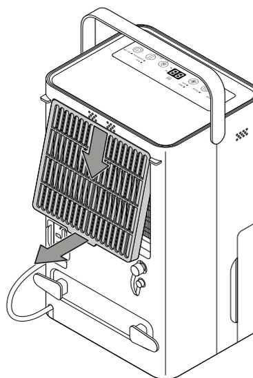
2. Rengjør filteret med en myk, lett fuktig klut som ikke loer. Dersom filteret er sterkt tilsmusset, kan du rengjøre det med varmt vann som er iblandet et nøytralt rengjøringsmiddel.
