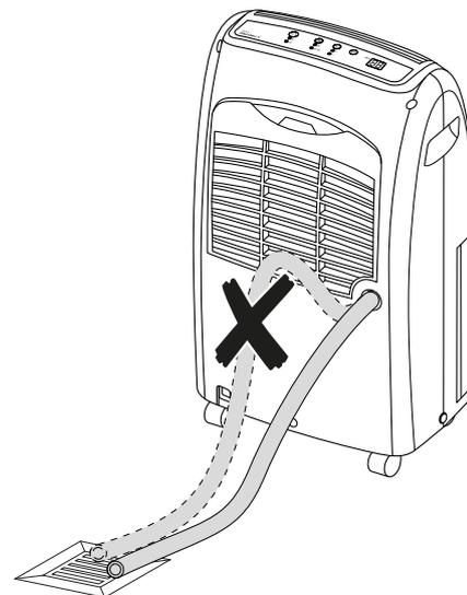
5. Проверьте, правильно ли шланг надет на патрубок. При необходимости откорректируйте положение через отверстие на емкости для конденсата.
