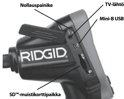
Kuva 4 – Vasemman puolen portin suojus
