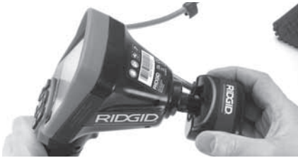
Εικόνα 19 – Βύσμα σύνδεσης κάμερας τοποθετημένο
