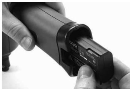
Figura 6 – Extracción e instalación de la batería
