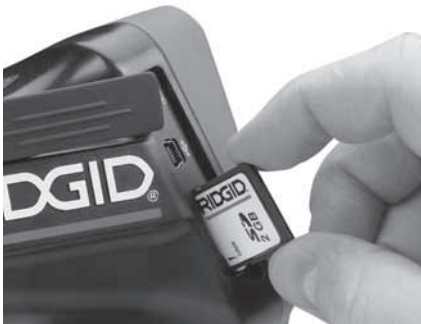
Figur 10 – Sätta in SD-kortet
