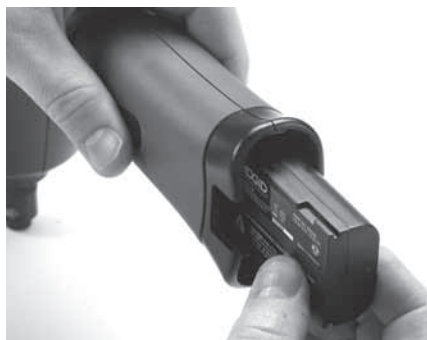
Obrázek 6 – Vyjmutí a instalace baterie
