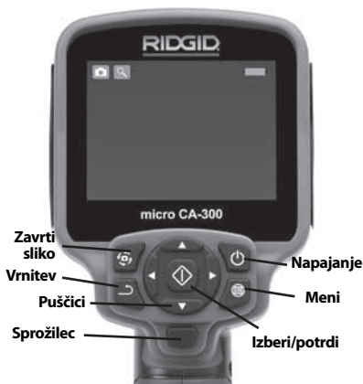
Slika 2 – Elementi za upravljanje
