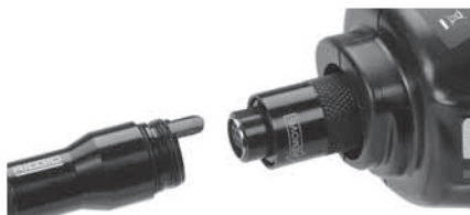
Figura 8 – Collegamenti del cavo
