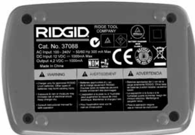
Figura 22 – Etiqueta de advertencias pegada en el cargador
