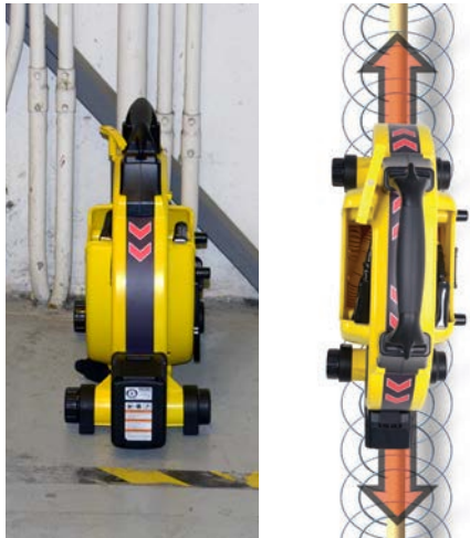
Figur 4 – Induktion med RIDGID SeekTech ST-33QR
